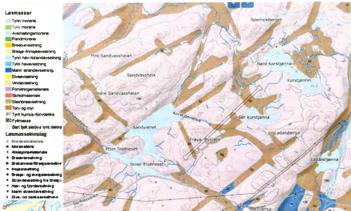
Figur 3. Løsmassedekket i området.
